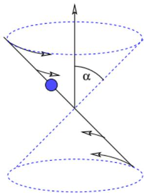
Eine Perle bewegt sich reibungslos entlang eines geraden Drahtes. Der Draht hat einen Winkel  $\alpha$  von der Vertikalen und dreht sich mit einer Frequenz  $\omega$ , wobei er einen Kegel nachzeichnet.
