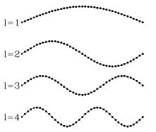
Zum Beispiel, bei  $N\gg 1$  Massen in einer Reihe sind die Eigenwerte  $\omega_\ell=\pi\ell\sqrt{M/D}$  und die N Eigenvektoren sind  $a_{i,\ell}=\sin(\pi\,i\ell/N)$ .
