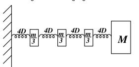
Ich kann m als N kleinere Massen, Masse m/N, und die Feder als N+1 Federn mit Federkonstanten (N+1)Dannähern
